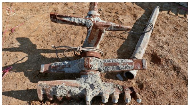
①柱状改良＝掘削機先端の攪拌翼でセメント系固化材を地盤に注入しながら土壤と混合攪拌し、化学的に固化させたセメント柱を地中に造成。強度はサンプル試験で $6.1\text{N/mm}^2$ 。これは角砂糖大で60kg以上に耐える硬さ。
